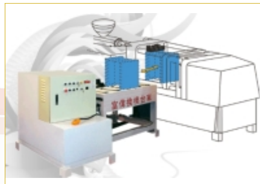
Die / Mold Cart System
