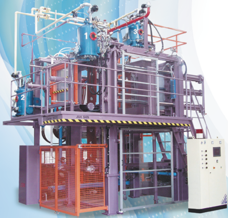
CARRIER-C Series 全自動真空成型機(雙密度成型)
