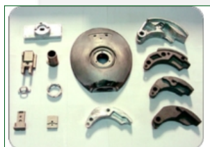
Zinc Die Casting
