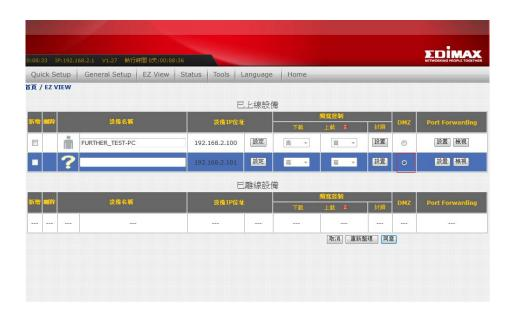
設定完成後將 IP 分享器重新啓動並移除 netTV BOX 電源 待 IP 分享器啓動完成在接上 netTV BOX 的電源
