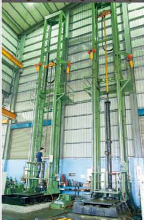
CNC擿孔加工機，長度6米 CNC boring machine (6m L)
