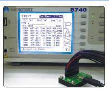
線材測試儀 NAC 系列機種量測 Type-c 線材, type-c 線材 有四種接頭迴路狀態(正正、正反、反正、反反),線材測 試儀會自動判斷迴路狀態。將四個迴路檔案用循序測試選取 後,即可開始測試。
