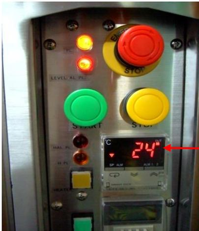
當洗淨液升溫至 50°C 後，預先設定好『計時器』的洗淨時間並開啟『洗淨超音波開關』『電解洗淨』
